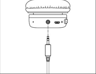
1. Verbinden Sie den Kopfhörer-Ausgang des Wiedergabegerätes über das beiliegende AUX-Kabel mit der Audio-Anschlussbuchse am Kopfhörer.
